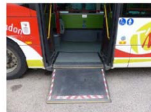
Rampe électrique avec agenouillement du bus, bouton d'appel extérieur et contrastes.
